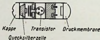
Bild 2. Skizze vom Aufbau der verschluckbaren Radiosonde (etwa natürliche Größe)
